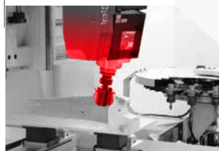
Groupe opérateur principal à 5 axes. Grâce à la nouvelle structure, le moteur 5 axes atteint n'importe quelle position de travail tout en garantissant une rigidité maximale pendant les usinages et une finition parfaite.
