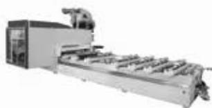
centres d'usinage à commande numérique 5 axes
