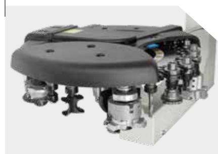
Vaste choix d'outils disponible grâce au changeur automatique, au magasin latéral et au changement d'outil à une position à démarrage pneumatique pour lames pouvant atteindre 350 mm de diamètre.
