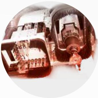
Groupe opérateur composé d'un électromandrin de 13 kW - HSK, d'une tête de perçage de 19 mandrins et d'un groupe de fraisage horizontal.
